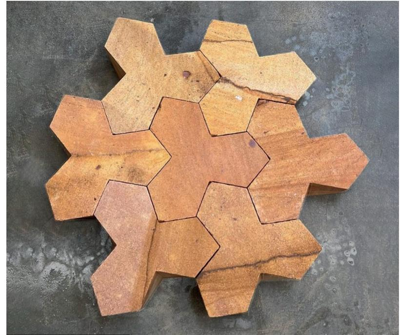
**ERSTEN ELEMENTE** (Bild oben) Nach einigen Testdurchläufen konnte die Präzision im Verfahren weitestgehend optimiert werden. Die sieben Interlockingsteine ergänzen sich zu einem eindrucklichen Mosaik, welches von den natürlichen Maserungen des Sandsteins einen einzigartigen Ausdruck bekommt. Die größte Schwachstelle des Materials sind jedoch die Kanten und Ecken. Sie sind anfällig für Abnutzung und erfordern einen besonders sorgsamen Umgang mit dem Material.
