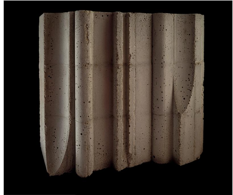
**PROOF OF CONCEPT** (Bild oben) als 15 x 16 cm Ausschnitt aus dem zuvor beschriebenen Schalsystem. Die einzelnen Formen wurden zuvor nach dem Beispiel echter Gewände modelliert und aus *Poly lactid* (PLA) 3D gedruckt. Die eingeschaltete Form wurde nun stellvertretend mit Zementmörtel gefüllt und aushärten gelassen. Beim Ausschalen haben sich die Stempel aus PLA als sehr trennfähig herausgestellt und konnten nach dem Einsatz leicht gereinigt und erneut genutzt werden.
