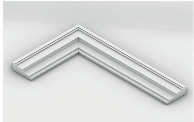
**DER NÄCHSTE PROTOTYP** (Bild oben) Hier das Positiv der Schalung. Wenn auch dieser Test glückt, ist der letzte Schritt ein vollständiges Gewände herzustellen
