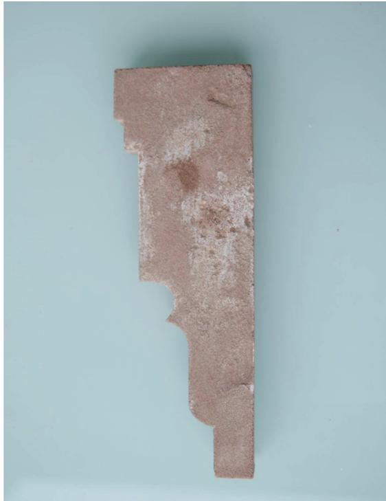
Anders als bei dem Interlocking Modul spielte bei dem „Gewändestein“ die Schärfe der Kanten, da diese maßgeblich die Ausdrucksstärke des entstehenden Profils bestimmt, eine große Rolle. Da es sich am Ende um ein volles Fenstergewände handeln soll, spielt auch die Festigkeit sowie die maximal herstellbare Größe einen entscheidenden Faktor. Nachdem Niklas Erdmann die ver-
